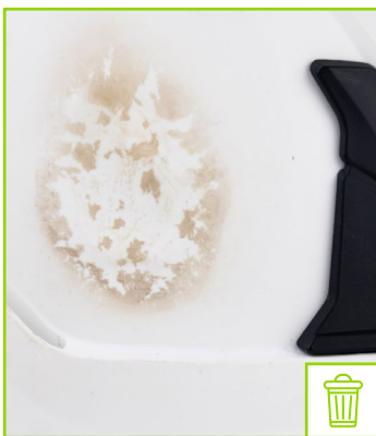
Außenschale mit Spuren einer chemischen Substanz
