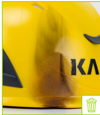
Calotta con segni di bruciatura da fiamma
