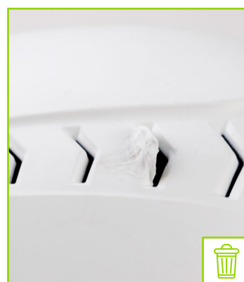
Carcasa con orificio de ventilación deformado
