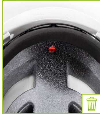
Innenschale mit Flammenbrandspuren
