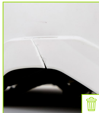
Fessura di fissaggio accessori fessurata
