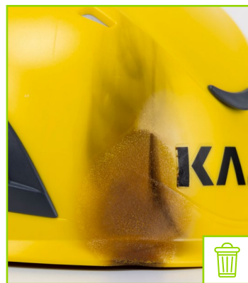
Außenschale mit Flammenbrandspuren
