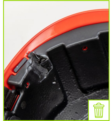
Innenschale mit Verformung
