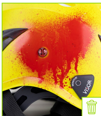
Carcasa con presencia de pintura
