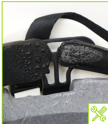
Rembouillage avec marques de brûlure de flamme
