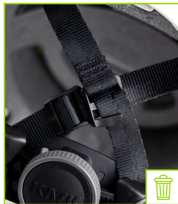
Hintere Verstell Schnalle gebrochen
