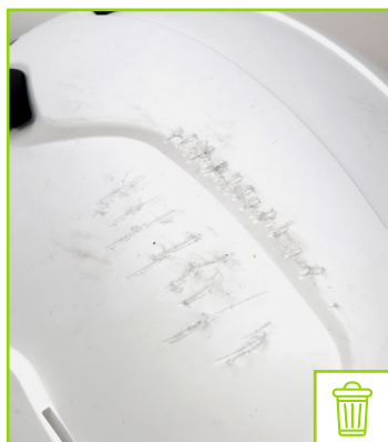
Carcasa con ranuras profundas
