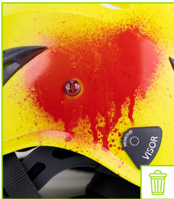
Calotta con presenza di vernice
