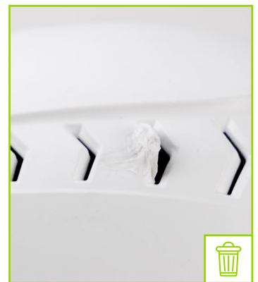
Außenschale mit verformtem Lüftungsloch
