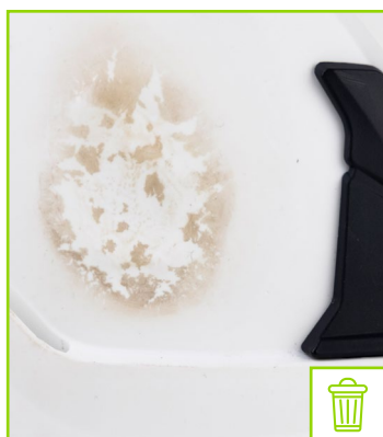
Coque externe avec traces de substances chimiques
