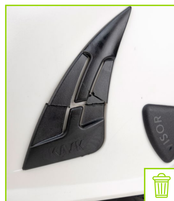
Clip para uso de linternas roto
