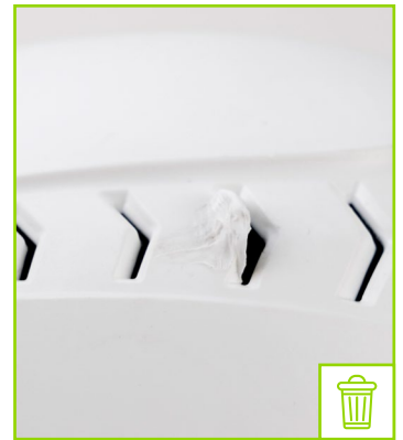
Calotta con foro di aerazione deformato
