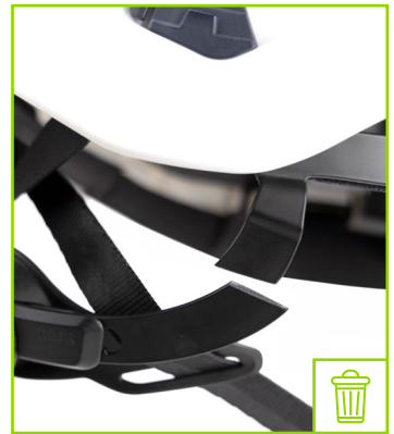
Gebrochene Zahnstange des Verstellsystems
