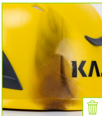
Coque externe avec traces de brûlures de flamme
