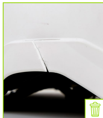
Zubehöraufnahmeschlitz mit Rissen
