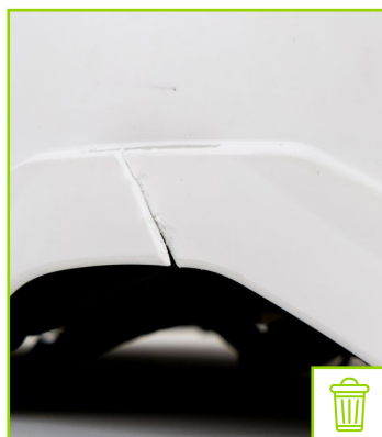
Ranura de fijación de accesorios agrietada
