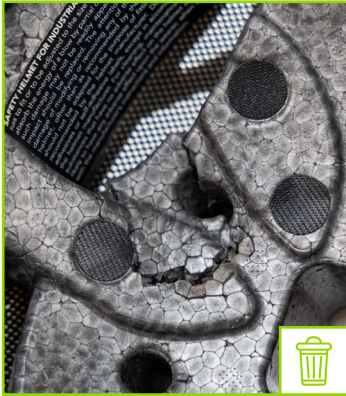
Calotta interna fessurata
