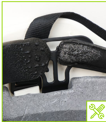
Füllung mit Flammenbrandspuren
