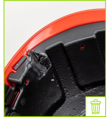
Coque interne déformée
