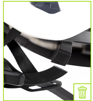
Ramo del sistema di regolazione rotto
